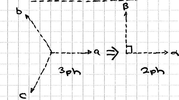
$$\begin{bmatrix} i_d \\ i_q \end{bmatrix} = \frac{2}{3} \begin{bmatrix} 1 & -0.5 & -0.5 \\ 0 & \sqrt{3}/2 & -\sqrt{3}/2 \end{bmatrix} \begin{bmatrix} i_a \\ i_b \\ i_c \end{bmatrix}$$
