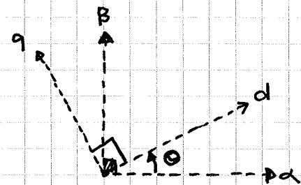
$$\begin{bmatrix} i_d \\ i_q \end{bmatrix} = \begin{bmatrix} \cos \theta & \sin \theta \\ -\sin \theta & \cos \theta \end{bmatrix} \begin{bmatrix} i_a \\ i_b \\ i_c \end{bmatrix}$$
